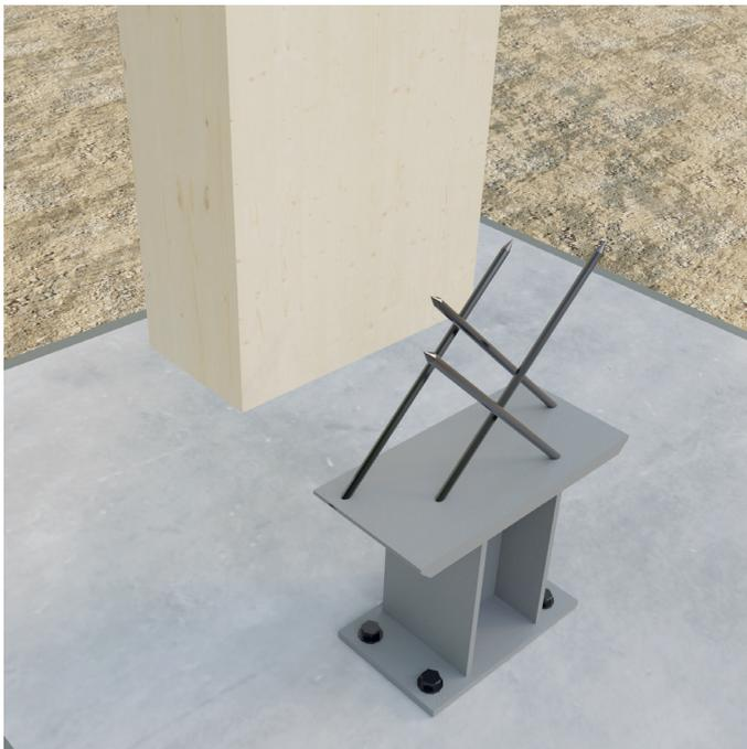
Stützenfuß mit Schrägschrauben auf Holzstütze vormontiert. Laschen für Aussteifungsverband möglich. Aufnahme von Bautoleranzen mit Millimeterblech und anschließendes Verfüllen mit Vergussmörtel möglich.
