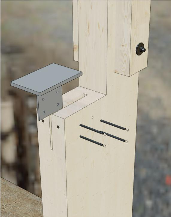
Kranbahnstütze mit Auflagerstahlteil für bauseite Kranbahn.
