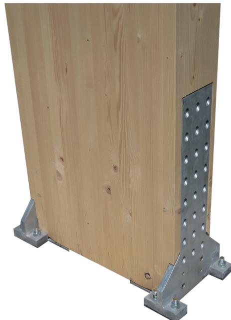
Für Stützen ohne Stahlsockel (Innenraum oder auf Betonsockel. Anschluss über Schrägschrauben, Auflagerstahlteil mit Gewindestangen in Fundament eingearbeitet.
