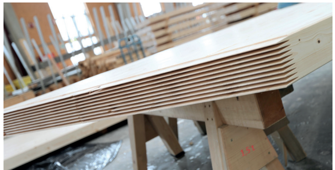
passgenaue Fräsungen im Handabbund
