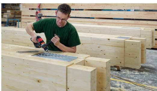
Montage der Stahlteile im Werk für eine Plug and Play Montage
