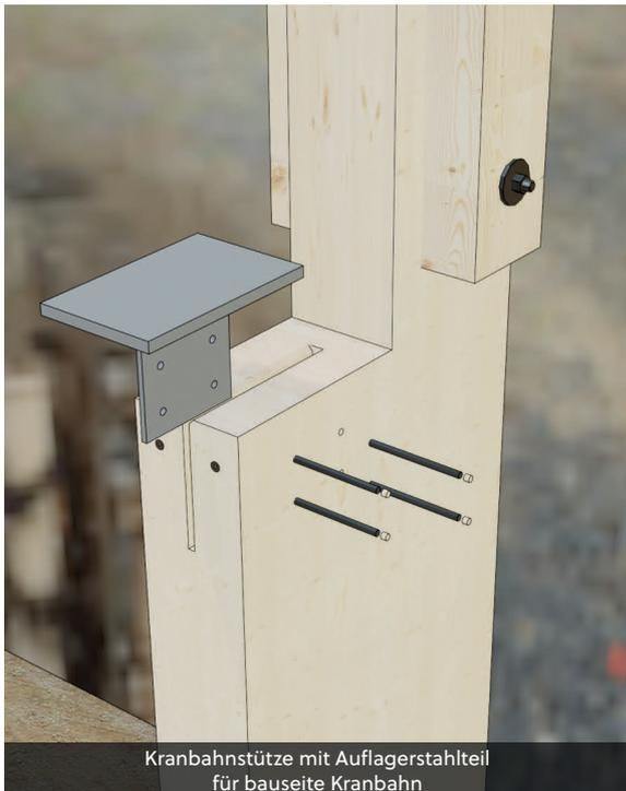
Kranbahnstütze mit Auflagerstahlteil für bauseite Kranbahn
