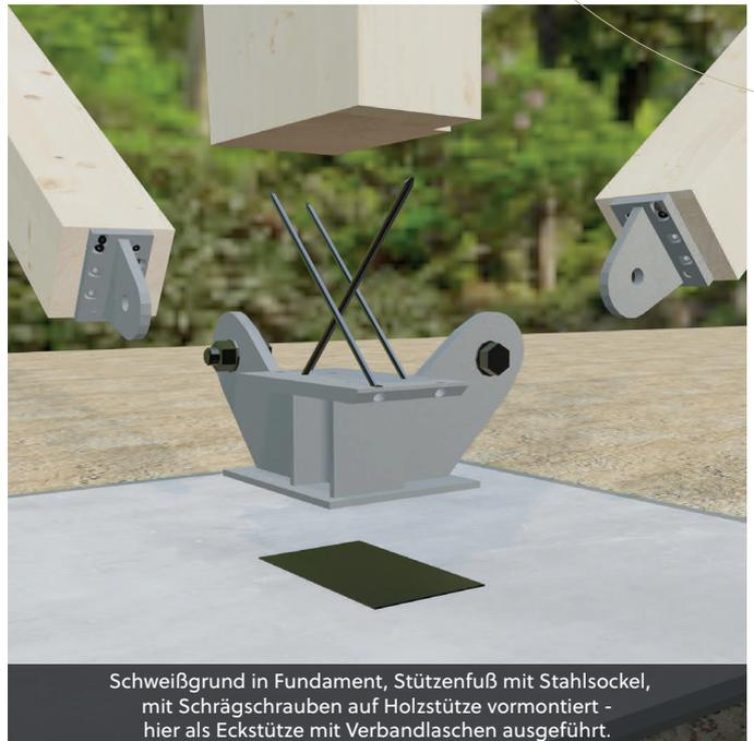
Schweißgrund in Fundament, Stützenfuß mit Stahlsockel, mit Schrägschrauben auf Holzstütze vormontiert - hier als Eckstütze mit Verbandlaschen ausgeführt.
