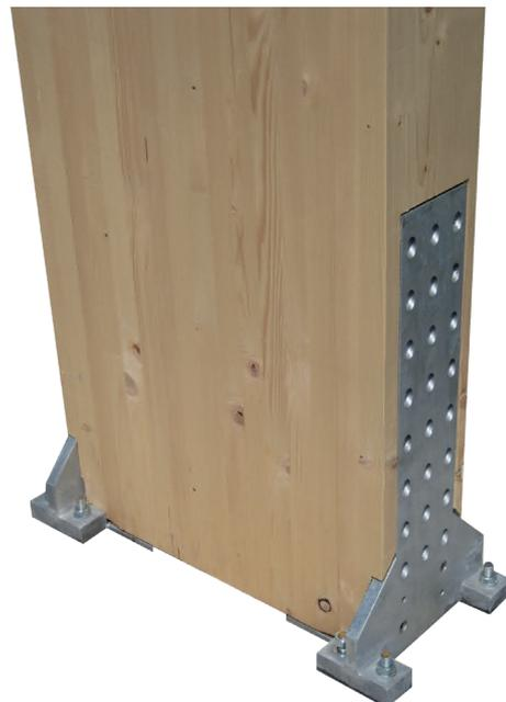
Für Stützen ohne Stahlsockel (Innenraum oder auf Betonsockel). Anschluss über Schrägschrauben, Auflagerstahlteil mit Gewindestangen in Fundament eingearbeitet.
